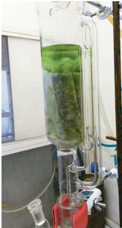
Экстракция хвои сосен в аппарате Сокслета
