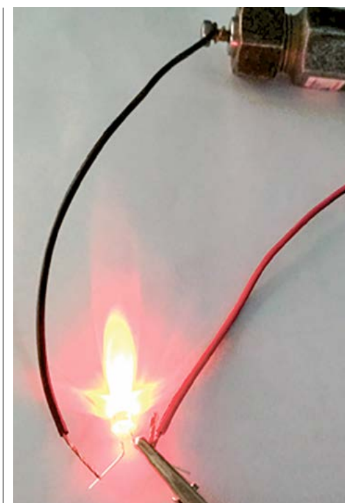
Единичный элемент натрий-ионного аккумулятора
