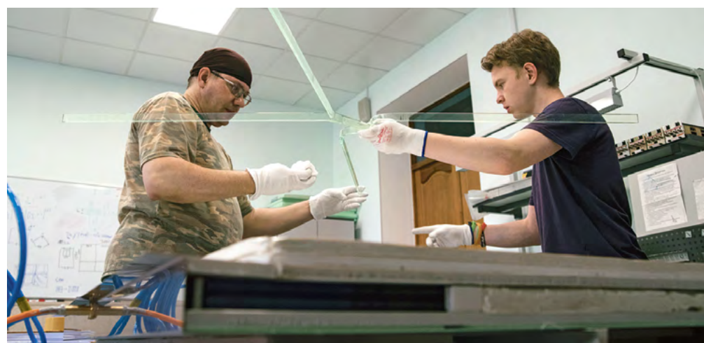
Деталь детектора, которую окрестили «паук», — переизлучатели спектра
