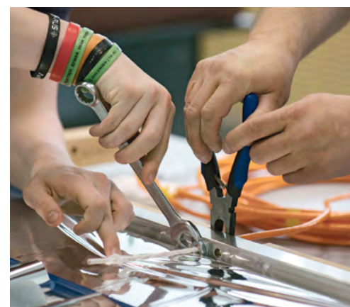
Герметизация кабеля
