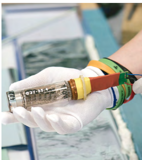
Одна из основных деталей счетчика — фотоэлектронный умножитель — регистрирует вспышки в скintилляторе от пролета частицы
