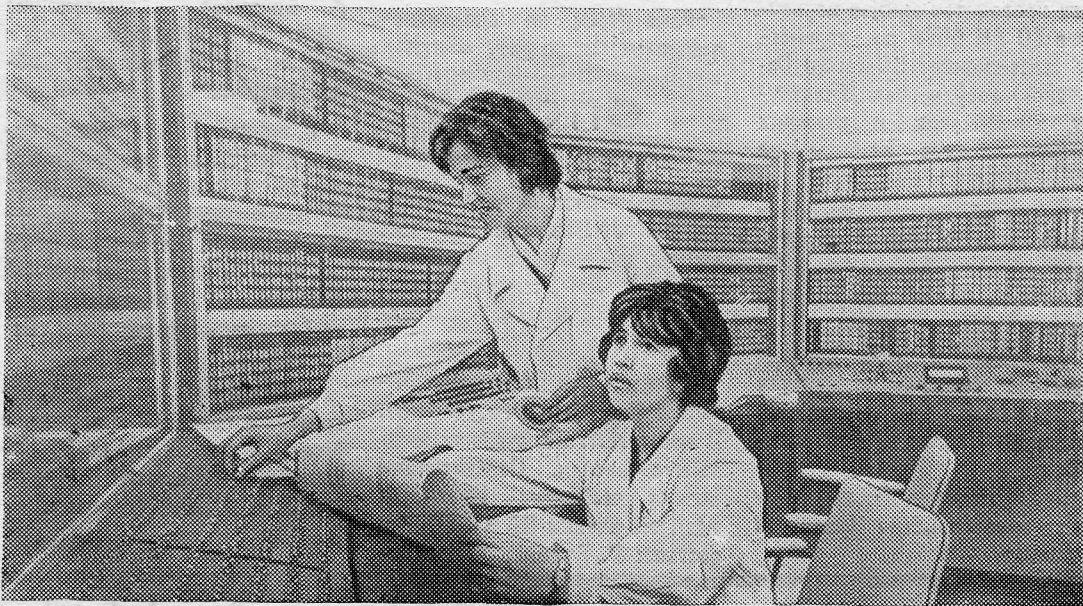
В Вычислительном центре СО АН СССР идет отладка «машины-миллисера» — БЭСМ-3, делающей миллион операций в секунду. За пультом инженеры Лена Лозовская и Люда Васильева.
