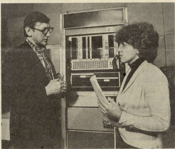
Заканчивается отладка автоматизированной системы сбора данных аэродинамической трубы Болгарского института гидродинамики судна. Работа ведется в ИГПМ СО АН СССР по контракту с НРБ.
