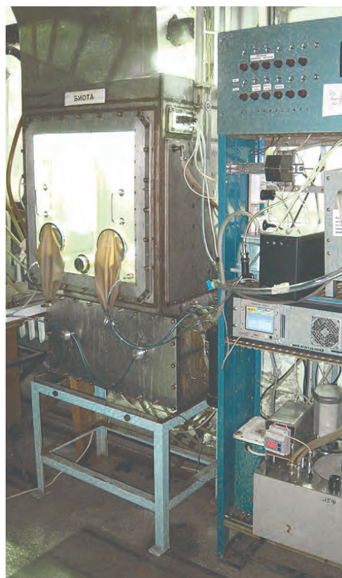
Установка «Биота» для исследования реакции почвы на изменение климата. Герметичная камера с контролируемыми условиями (слева) и система газоанализаторов (справа)
