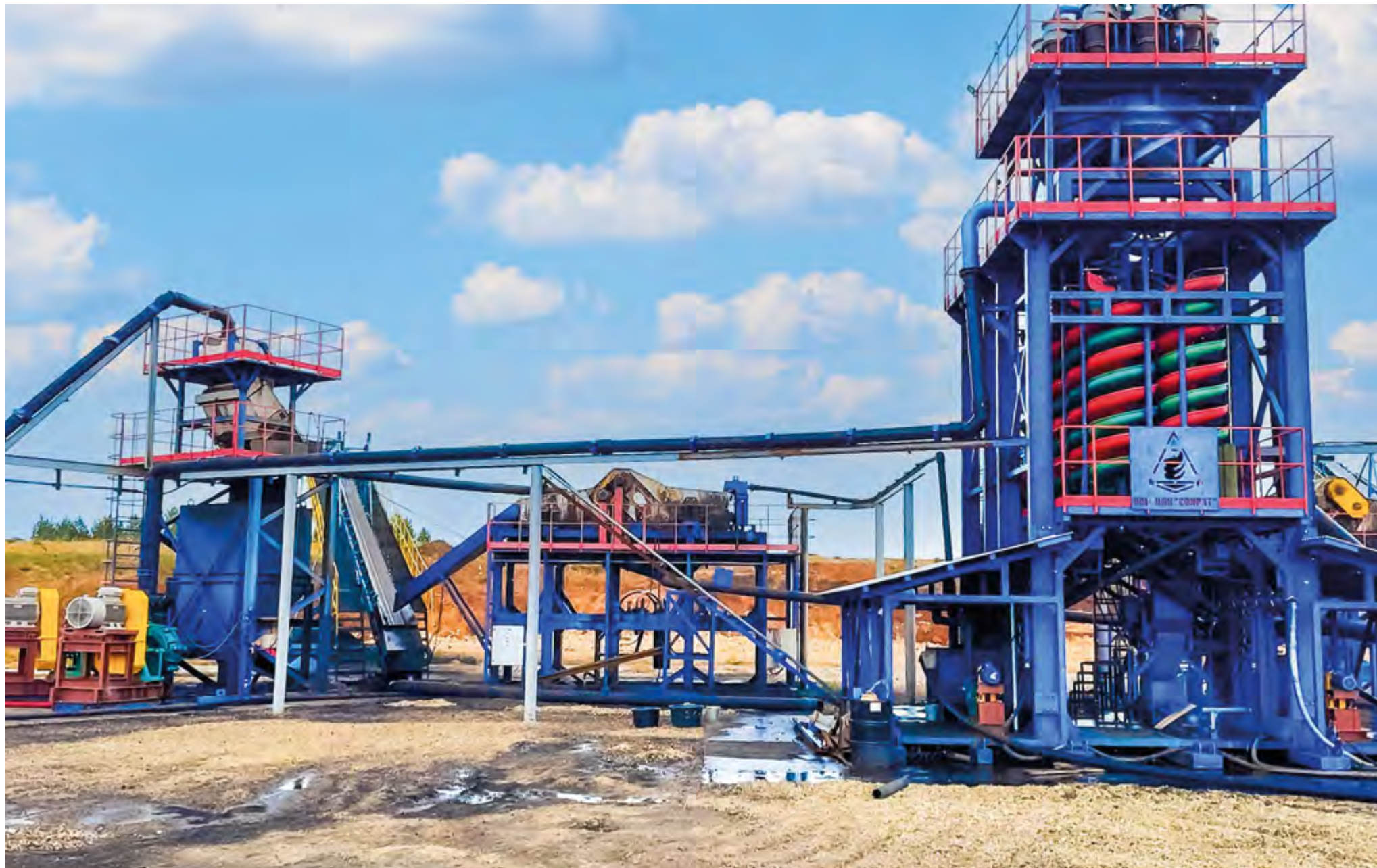
Опытно-промышленная магнитно-гравитационная установка для переработки техногенных отходов (угольных хвостов и отвалов)
