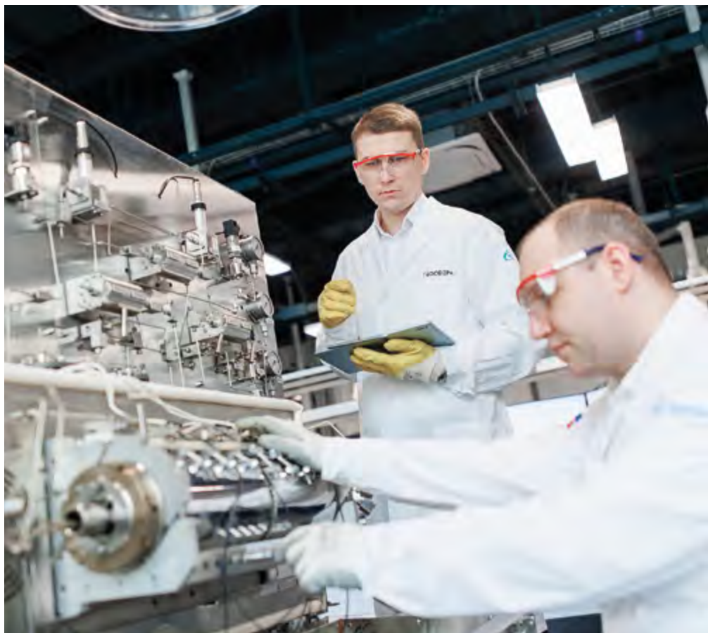
Специалисты центра «Геосфера» работают с установкой для испытаний материалов в условиях, близких к пластовым
